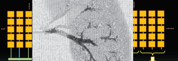
このノイズは、現にFPDで発生する。そこで、均一な被写体を撮影し、このノイズを収集して実際の画像にはその逆のパターンを補正として使用する。ノッチ型フィルタが有効な場合もある。
