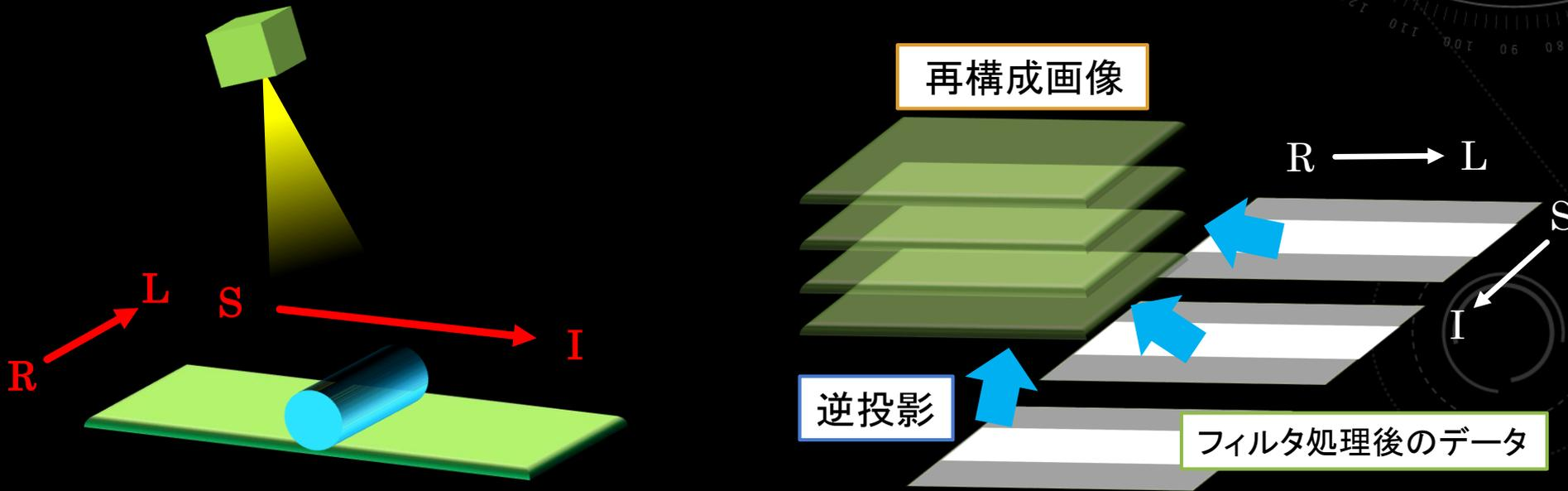
シフト加算法に比べ計算時間は延長するが、障害陰影を抑制し、コントラストも改善することができる。
